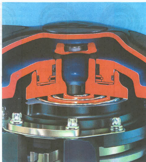
Figura 23-49 Dos involutas con forma de espiral acopladas una dentro de la otra. Cortesía de Emerson Climate Technologies
