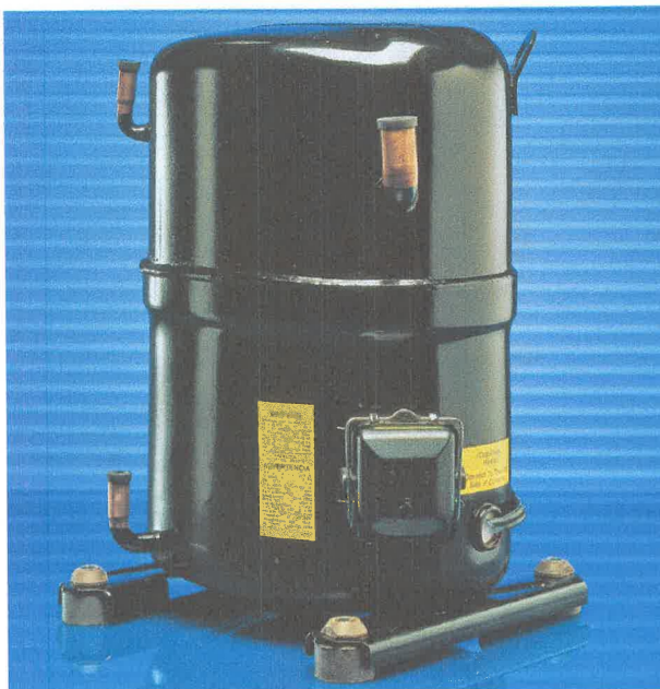
Figura 23-11 El compresor hermético soldado se utiliza en los compresores más pequeños, desde fracciones de caballo de potencia hasta a aproximadamente 50 hp. La mayoría de los compresores herméticos soldados tienen algunas cosas en común. El conducto de aspiración por lo común está conectado de manera directa en la carcasa y está abierto al cárter. El conducto de descarga normalmente está conectado del interior del compresor al exterior de la carcasa. La carcasa del compresor por lo general se considera como un componente del lado de baja presión. Cortesía de Bristol Compressors, Inc.
