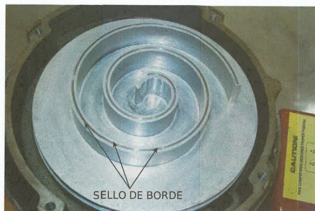
Figura 23-53 Elemento espiral que muestra un sello de borde para el sellado axial. Cortesía de la Ferris State University. Fotografía de John Tomczyk
