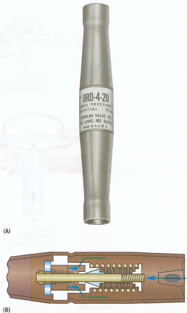
Figura 22-44 (A) Válvula de control de apertura por aumento de la presión de carga diferencial (ORD). (B) Vista en corte de una válvula de control ORD de la presión de carga. (A) y (B) Cortesía de Sporlan Division, Parker Hannifin Corp.
