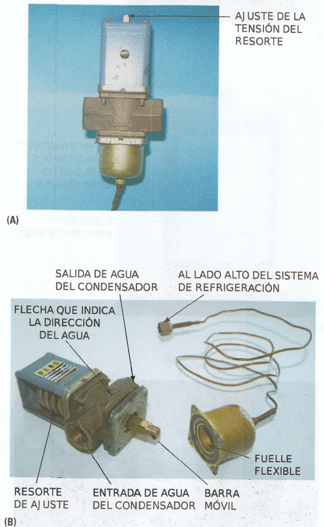
Figura 22-13 (A) Esta válvula de regulación del agua controla el flujo de agua durante periodos de demanda diferentes. (B) Componentes internos de una válvula de regulación de agua. (A) Fotografía de Bill Johnson. (B) Cortesía de la Ferris State University. Fotografía de John Tomczyk
