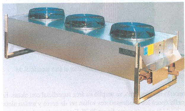
Figura 22-29 Condensador con patrón de flujo de aire vertical. El aire entra por la parte inferior y se sopla hacia la parte superior. Tiene la ventaja de que no se ve afectado por los vientos prevalecientes. Cortesía de Heatcraft, Inc., Refrigeration Products Division
