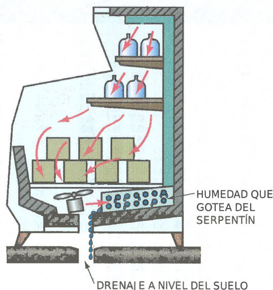
Figura 21-8 El serpentín de enfriamiento condensa la humedad del aire.
