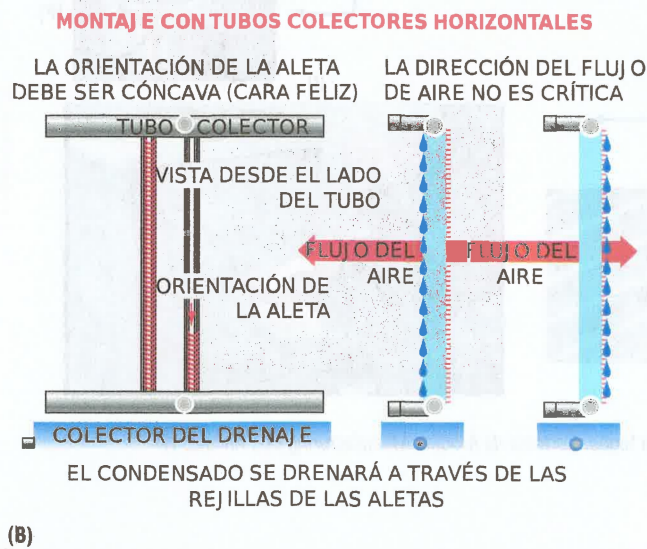
Figura 21-20 Remoción del condensado para una configuración vertical y horizontal del tubo colector. Cortesía de Modine Manufacturing Co., Racine, WI
